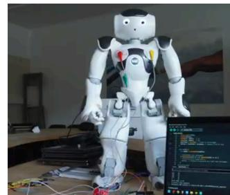
Il progetto si basa sull'utilizzo del modulo AD8232, un sensore progettato per rilevare l'attività elettrica del cuore (elettrocardiogramma). Gli elettrodi possono essere applicati in due configurazioni: sul torace o, in alternativa, sui due polsi e sulla gamba destra. Questi trasmettono il segnale elettrico al modulo, che provvede a filtrare e amplificare il tracciato.
